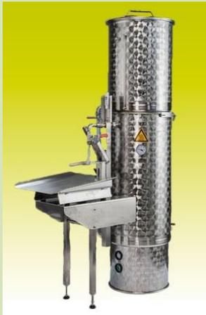
Förderung eines Pasteurisierers mit Abfüllung für Streuobstsäfte; der Betrieb kann nun kleinere sortenreine Chargen selbst verarbeiten. Große Chargen (Mischsäfte) werden zur Mosterei gebracht.
